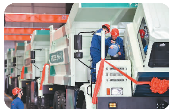
中铁长安重工有限公司研制的大吨位电机车组、纯电动装载机、纯电动出渣装备等新能源工程设备产销两旺，助力绿色建设。图为该公司工人在生产线上调试即将下线的95吨纯电动矿用自卸车。新华社记者 张博文摄
